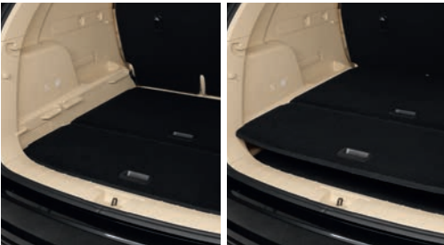
Двухпозиционный регулируемый пол багажного отсека
