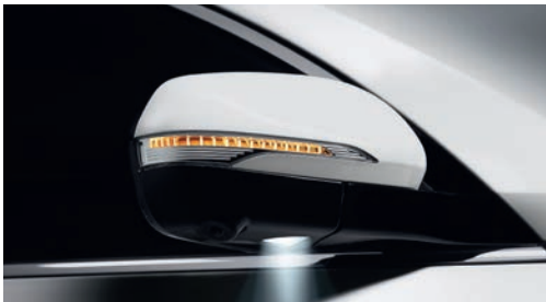
Повторители указателей поворота и лампами подсветки околodверного пространства в корпусах зеркал заднего вида
